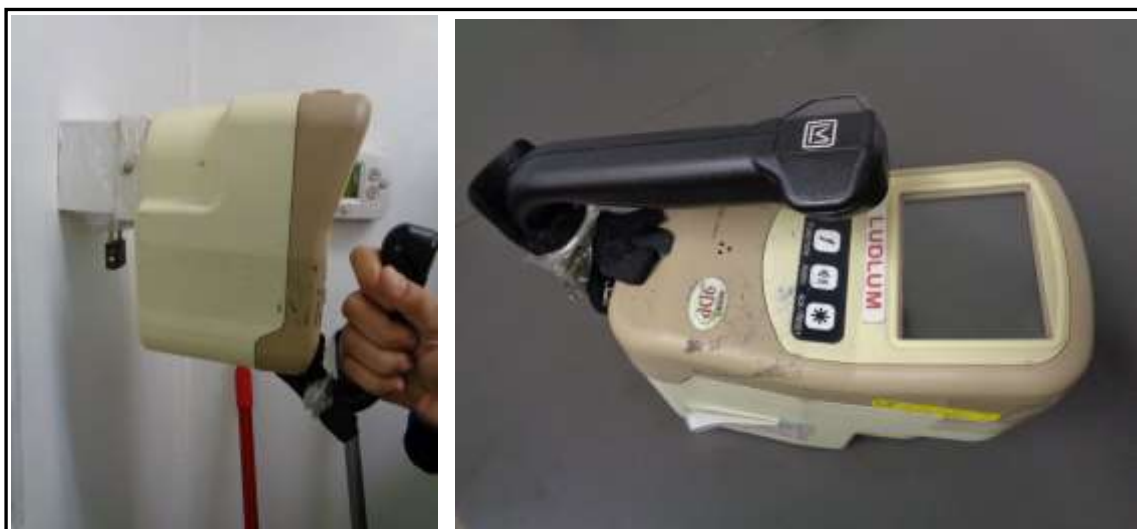
Figuras 16 – câmara de ionização sendo calibrada com a fonte de césio 137 e vista superior do equipamento.
